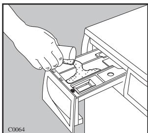
При наличии такой необходимости насыпьте смягчитель тканей в отделение дозатора, помеченное символом (не превышая отметку "MAX"). Осторожно закройте дозатор моющих средств.
